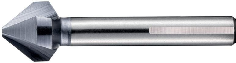
Le plus polyvalent des mandrins coniques et d'ébavurage professionnels avec une un pas inégal des trois arêtes de coupe principales et une tige à 3 faces pour des des lamages parfaitement circulaires. Le revêtement multicouche super dur nitrure de titane et d'aluminium (TiAlN) assure une longue durée de vie et un maximum d'efficacité. performance de haut niveau. Cette fraise conique à haute performance a été spécialement conçue pour les les perceuses sans fil.
