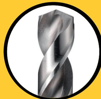
Ce foret hélicoïdaux standard affûté en acier rapide haute performance convainc par son rapport qualité-prix incomparable. Grâce à sa coupe croisée, ce foret hélicoïdal est autocentrant et ne nécessite qu'une faible force d'avance. Le foret hélicoïdal idéal pour les applications de perçage générales et bon marché.
