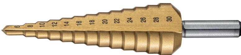
Ce foret étagé avec deux rainures de serrage droites et profondément rainures garantit un travail sans broutage jusqu'à une épaisseur de matériau de 4 mm. Grâce à son affûtage en croix, ce foret étagé est autocentrant et ne nécessite qu'une faible force d'avance. La tige à 3 faces assure une transmission optimale de la force lors d'une utilisation manuelle.
