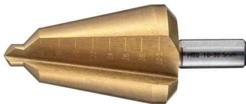
Avec pointe affûtée, pré-perçage inutile. Arêtes à conicité croissante et dépouille radiale de la circonférence à la meule permettant d'obtenir une coupe conique. Graduations indiquées dans les goujures. Queue avec 3 méplats. Revêtement HSS-G avec TiAlN pour l'usinage à sec, durée de vie optimale et vitesses de coupe maximales. Goujures hélicoïdales pour une évacuation sûre des copeaux.
